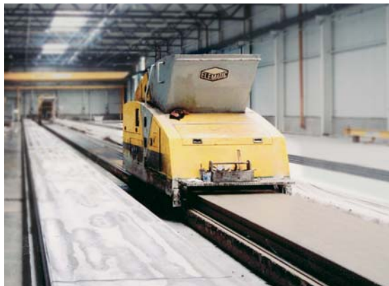
Prefabrikované stropní dílce STROPSYSTEM se vyrábějí na dlouhé dráze pomocí extruderu, který vytváří obdélníkový průřez vylehčený podélnými dutinami.
